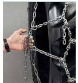
Yhdistä kulutuspinnan railoliitoslenkit toisiinsa jonka jälkeen sivulukot; ensin sisäpuolinen lukko. Älä unohda jälkikiristystä lyhyen ajan jälkeen. Kettinki on sopivan kireä jos nyrkki sopii renkaan sivun ja sivukettingin väliin.
