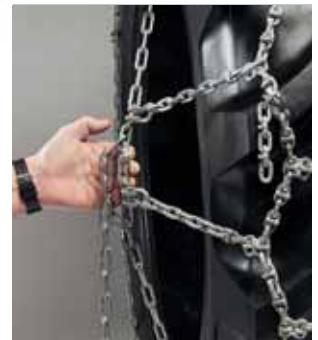
Yhdistä kulutuspinnan railoliitoslenkit toisiinsa jonka jälkeen sivulukot; ensin sisäpuolinen lukko. Älä unohda jälkikiristystä lyhyen ajan jälkeen. Kettinki on sopivan kireää jos nyrkki sopii renkaan sivun ja sivukettingin väliin.
